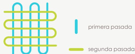
Pulverice utilizando trazos continuos y paralelos que se superpongan en un 20 % a una velocidad constante, a fin de que se forme una capa uniforme sobre una sección de un molde grande o sobre todo el molde de un tamaño más pequeño.
